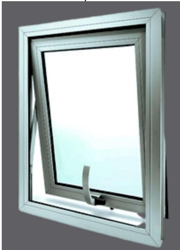
Vidrio de silicato sodocálcico templado, incoloro, de 6 mm de espesor, fijado sobre carpintería con acuñado mediante calzos de apoyo perimetrales y laterales, sellado en frío con silicona sintética incolora (no acrílica), compatible con el material soporte.
